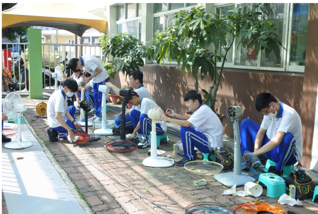
進行立扇的馬達與轉心層灰清潔保養及上油，讓長者在使用上能安心。
